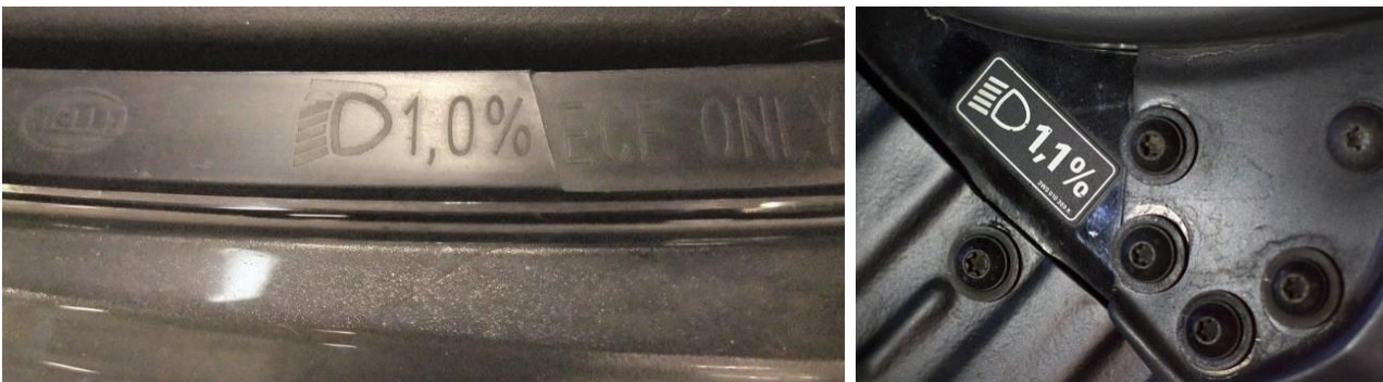
Рисунок 2.8 – Приклади позначення кута нахилу світла фар
